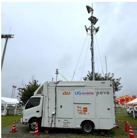
<5G 対応の車載型基地局（左）／飲食エリアにおける Wi-Fi 提供（右）>
