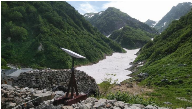
< 劔岳 真砂沢ロッジに設置した Starlink アンテナ >
